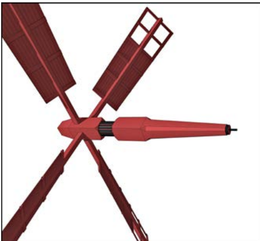
Ritning 1: Väderkvarnens maskineri. Vingarna och vingarmen. Ritning: © Stephan Horn.
