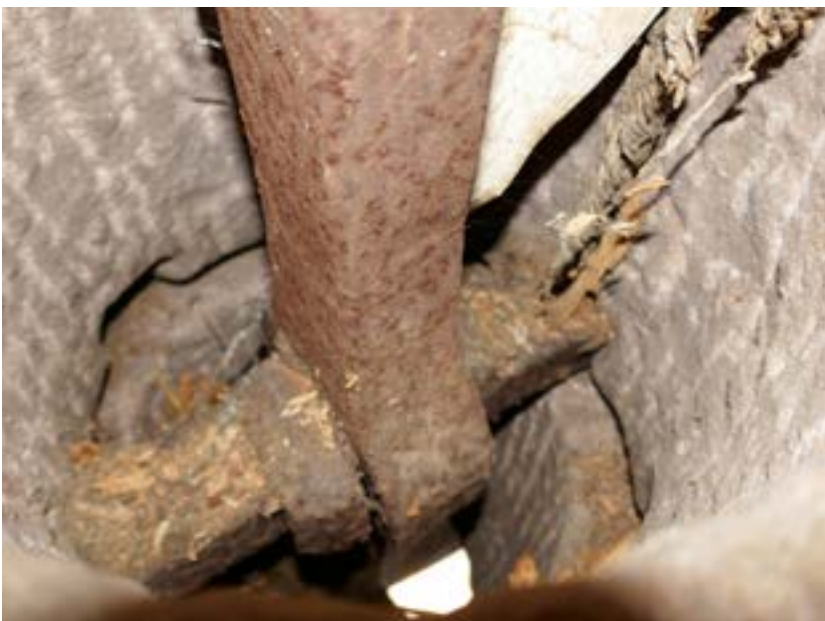
Foto 9: Denna vy genom löparens öga är ovanligt tydlig, eftersom liggarens tapp har trillat bort och seglet sitter i lyktans grepp. Foto: Kirsti Horn
