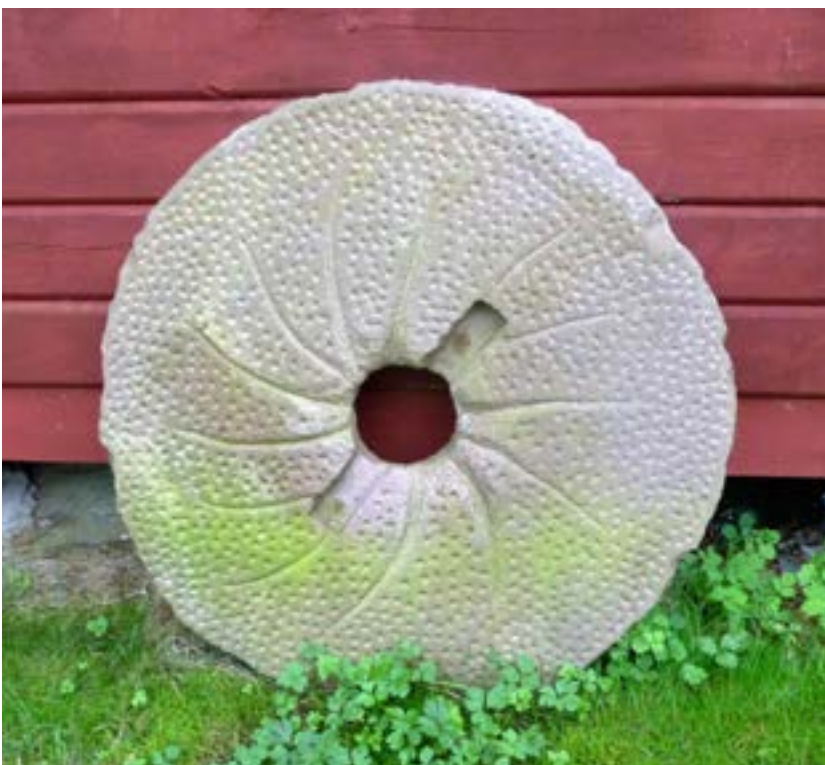
Foto 5: En vacker löparsten, som har bevarats från en igenrasad kvarn. Lägg märke till fördjupningarna i seglets järn. Foto: Kirsti Horn, 2016.
