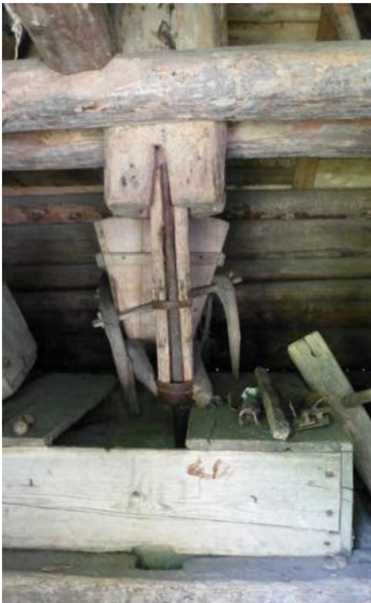
Valokuva 17: Ontto napatukki ja sen sisässä lyhdyn akseli Sagalundin museon harakkamyllyssä. Kuva: Kirsti Horn, 2016.
