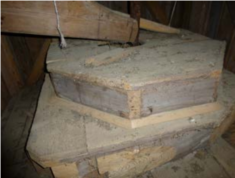
Valokuva 3: Kahna ympäröi jauhinkivet ja estää jauhон karkaamisen työtilaan. Kuva: Kirsti Horn, 2016.
