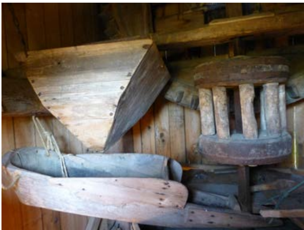
Foto 1: Tratten som kornen hälldes i och skon som ledde dem till kvarnögat har olika utförande i alla kvarnar. Foto: Kirsti Horn, 2016.
