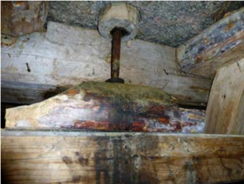
Foto 7: Nålen rullar i sin fettkopp, tränger igenom kvarnögats trätapp och driver löparstenen med seglets förmedling. Husbonden Veikko Kotirantas sammanfattar proceduren: "Hela maskineriets roterande koncentreras till en yta stor som en slant". Foto: Kirsti Horn, 2016.
