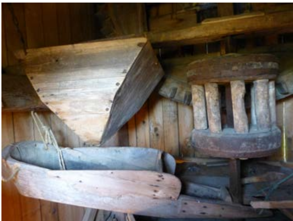
Valokuva 1: Tuutti, johon jyvät kaadettiin ja porsas, joka johti ne kiven silmään ovat joka myllyssä erilaista muotoilua. Kuva: Kirsti Horn, 2016.
