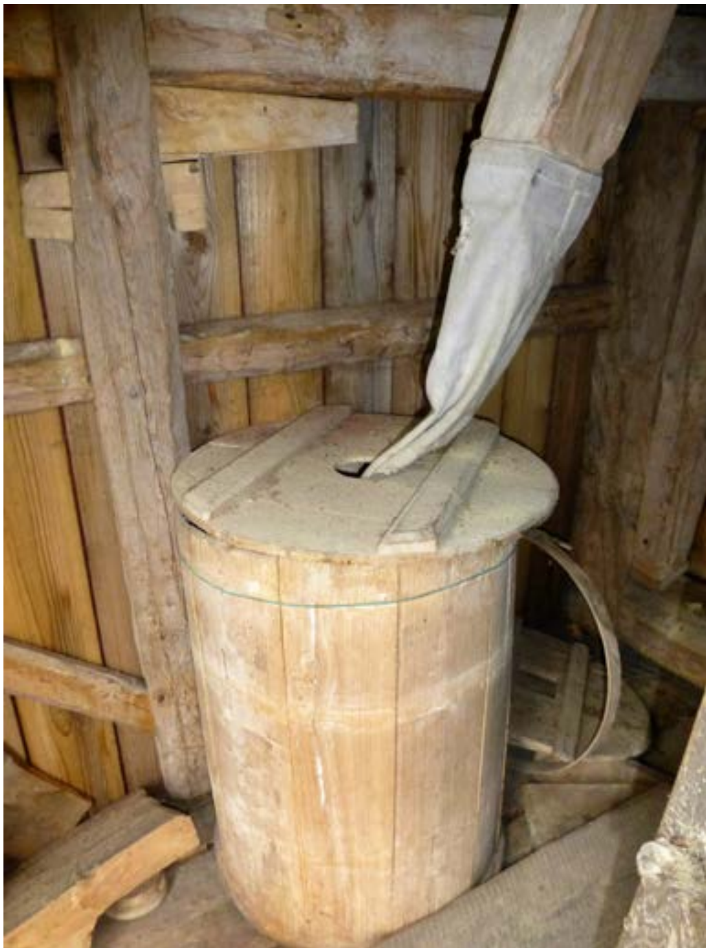
Foto 6: Röret av trä förlängdes ofta med ett tyg. De den bakre väggen syns liggarens reglage. Foto: Kirsti Horn, 2016.
