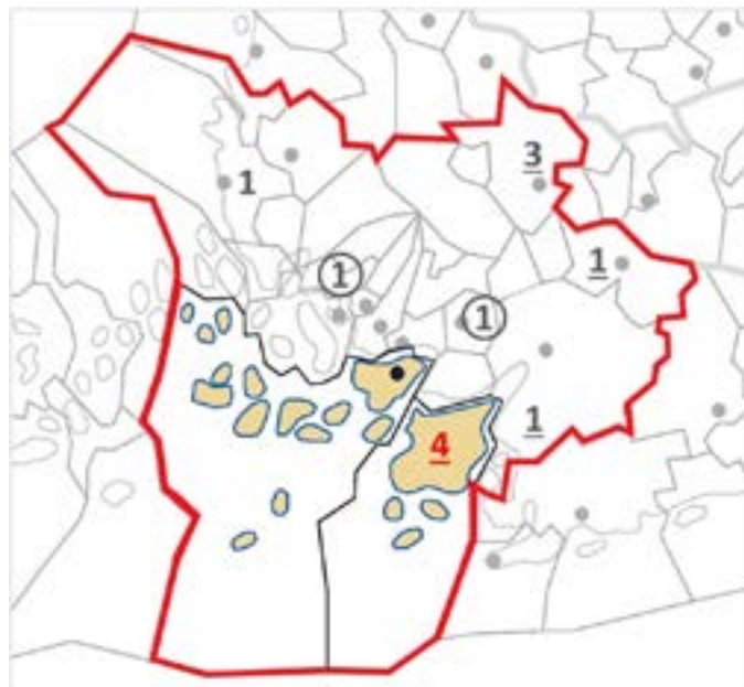
Kartta 5: Pystyssä olevat harakkamyllyt Varsinais-Suomessa vuonna 2017: yhteensä 12 kpl, joista 4 Turunmaalla. Alleviivaus osoittaa ne 9, joissa on neliömäinen pyramidikattoinen alaosa ja kapea yläosa; rengas suuret myllyt, joissa on kaksi kiviparia.
