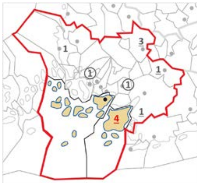
Karta 5: Resta holkkvarnar i Egentliga Finland år 2017: sammanlagt 12 st, av vilka 4 i Åboland. Understreckningen betecknar 9 kvarnar, som har en kvadratisk underdel med pyramidtak och en smal överdel; med ringar betecknas stora kvarnar, med två par stenar.
